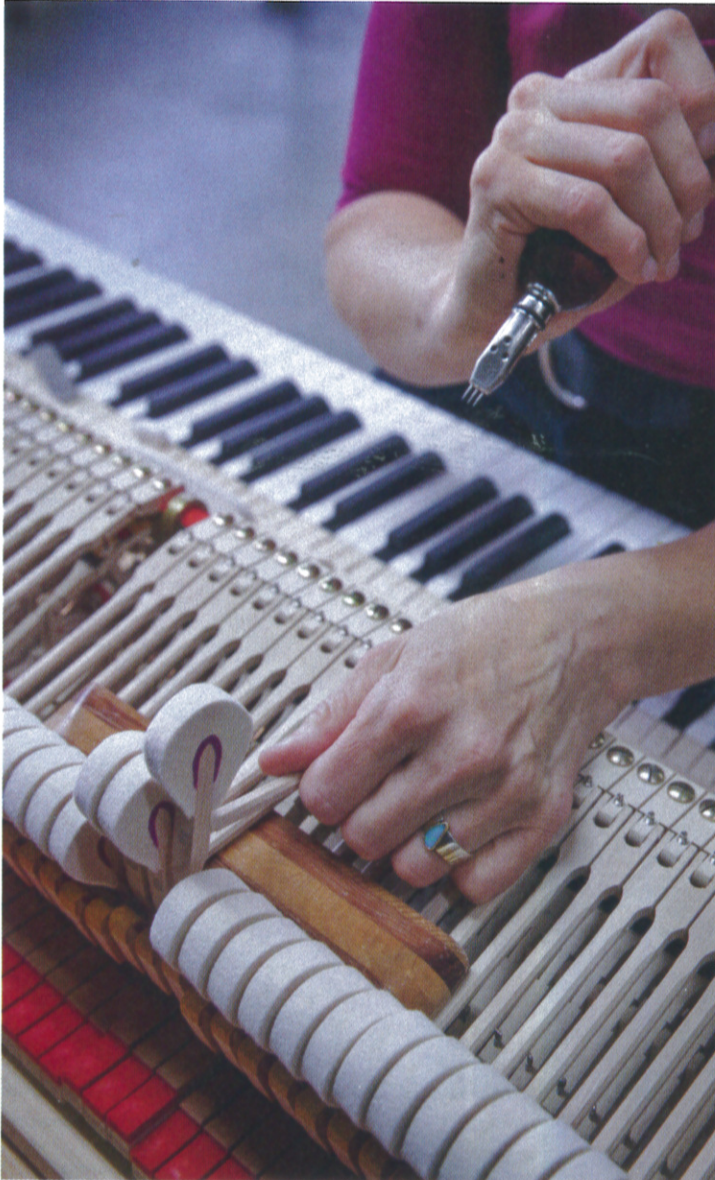
Pour modifier l'intonation, Wiebke Wunstorf pique les extrémités en feutre des marteaux avec un outil surmonté de trois aiguilles.
